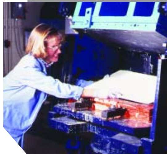
Una parte hecha mediante RTM
